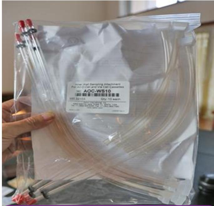
**Accesorio para Muestreo de Pared Interior. Los usamos para muestrear debajo de los gabinetes, no en las paredes.**
