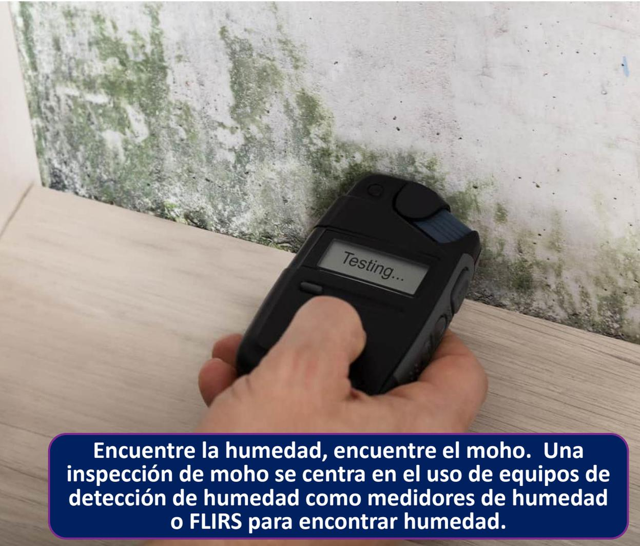
**Encuentre la humedad, encuentre el moho. Una inspección de moho se centra en el uso de equipos de detección de humedad como medidores de humedad o FLIRS para encontrar humedad.**
